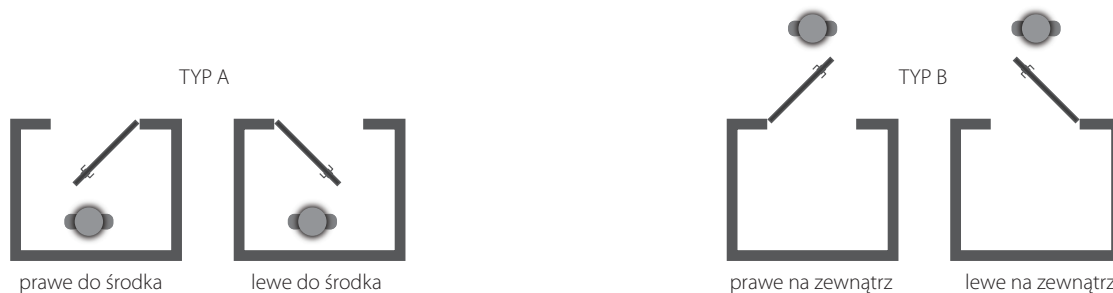
Rys. 2 – SCHEMAT OKREŚLANIA KIERUNKÓW OTWIERANIA DRZWI DLA OŚCIEŻNIC TYP A I TYP B
